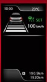
Prikaz postavki prilagodjivog tempomat-a; nadzor brzine vozila i udaljenosti vozila ispred
