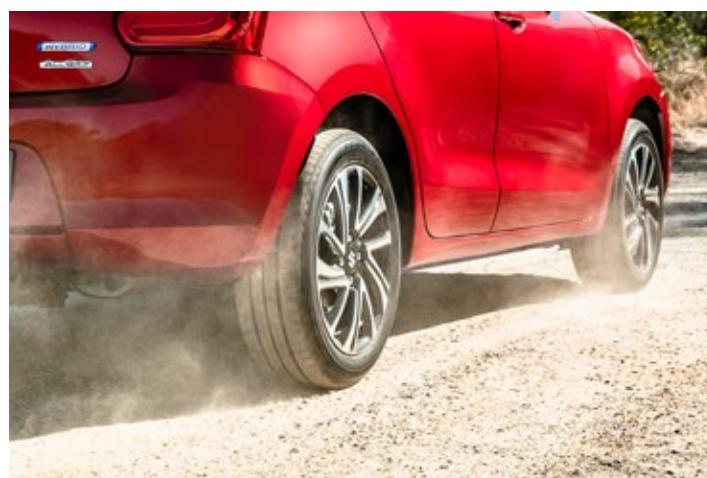
ALLGRIP AUTO je optimalan 4WD sustav koji pruža vozaču bezbrižnost u svakodnevnoj vožnji, pogotovo kada se vozi po skliskim cestama ili snijegom pokrivenim površinama. Pomoću viskozne spojke sustav pogona na četiri kotača automatski raspodjeljuje okretni moment prema stražnjim kotačima kada prepozna da prednji gube kontakt s cestom.
