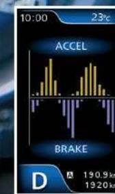
U stvarnom vremenu prikazuje korištenje papučice gasa i kočnice
