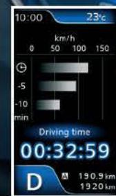
Prikazuje prosječnu brzinu i spremljenu prosječnu brzinu vozila
